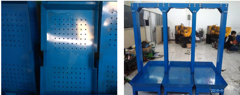
Gambar 5. Proses pabrikasi alat press hidrolik multi gawang
