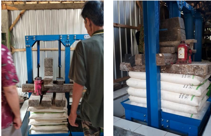
Gambar 7. Proses uji coba alat press hidrolik dan penggunaan oleh mitra
