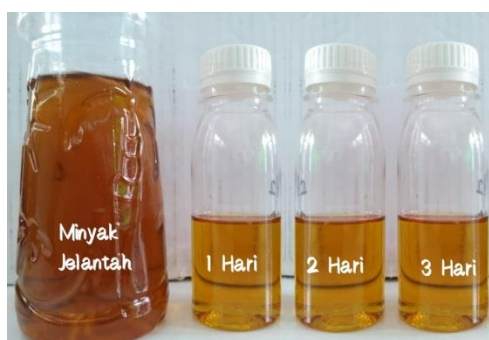
Gambar 2. Perbandingan warna minyak jelantah dengan ampas tebu berukuran 80 \mu\text{m} .
