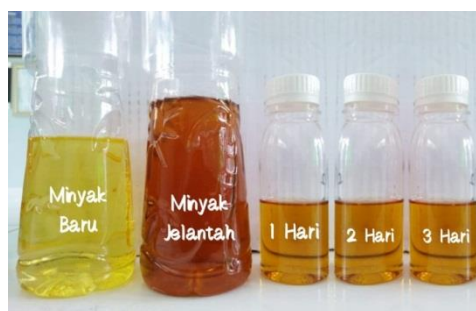
Gambar 1. Perbandingan warna minyak jelantah dengan ampas tebu berukuran 60 \mu\text{m}
