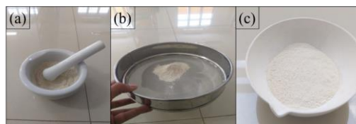
Gambar 1. (a) ZAL, (b) Proses penyaringan ZAL, (c) ZAL hasil aktivasi
