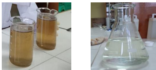
Gambar 1. Perubahan karakteristik visual limbah POME sebelum (berwarna keruh) dan sesudah proses oksidasi Fenton (lebih jernih).
