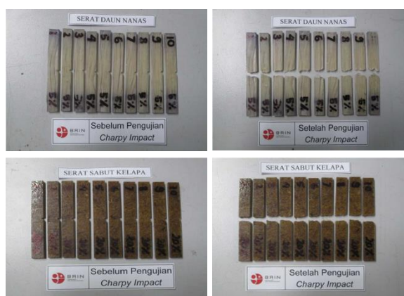
Gambar 3. Kondisi Sebelum (a) dan Setelah (b) Pengujian Impak
