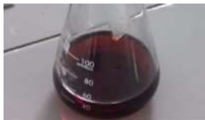
Gambar 2. Asap cair yang dihasilkan dari pirolisis kulit jagung.
