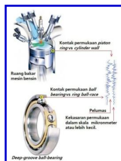
Gambar 1. Gesekan yang terjadi pada piston-ring dan ball-bearing (Aghurri,2010)
