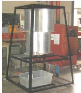
Gambar 3. Model pompa dengan penggerak turbin angin buatan Bondan (2007)
