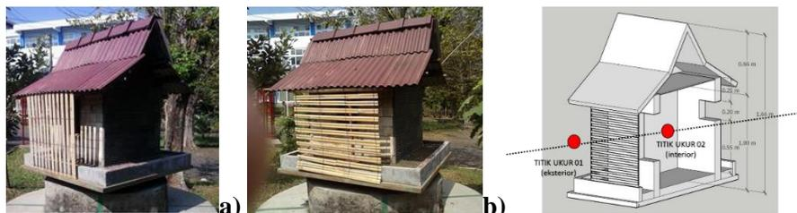
**Gambar 3.** a) foto model bangunan miniatur dengan krey horisontal dan b) krey vertikal dan c) posisi titik ukur
