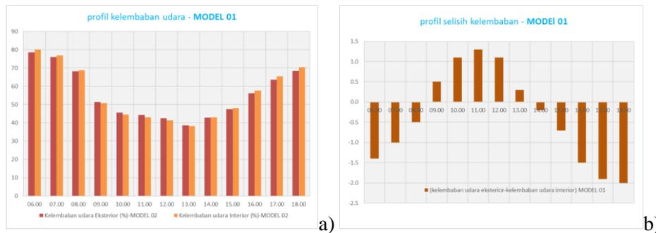
**Gambar 5: Profil kelembaban udara model 01 : a) grafik hasil pengukuran, b) grafik hasil perhitungan selisih suhu udara interior terhadap eksterior**
