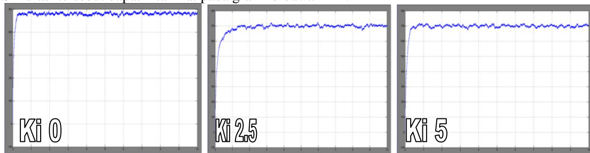
Gambar 7. Grafik putaran motor dengan menggunakan K_p 1, K_i 0, 2.5, 5 dan K_d 0,1
