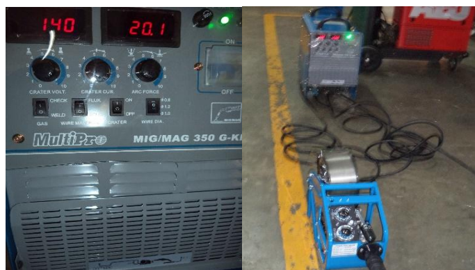
Gambar 2. Ampere dan Voltage pengelasan GMAW
