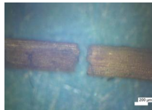
Gambar 5. Foto mikro patahan brittle fracture (patah getas) 0% NaOH
