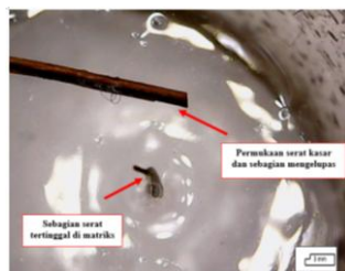
Gambar 16. Spesimen uji pull-out perlakuan alkali 5% NaOH
