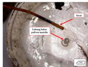
Gambar 14 . Spesimen uji pull-out tanpa perlakuan
