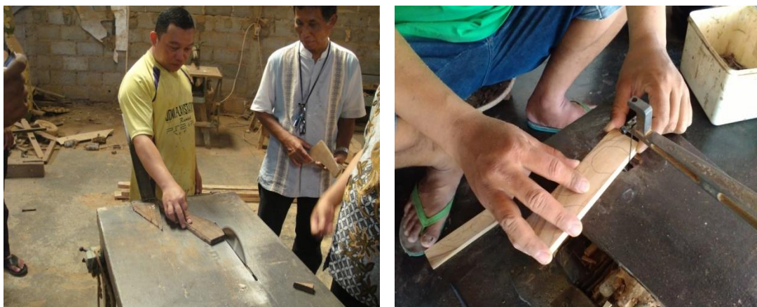
Gambar 3. Penggergajian menggunakan gergaji piringan dan scroll saw Sumber : Kegiatan Pengabdian Masyarakat Program PPPE Tahun 2018
