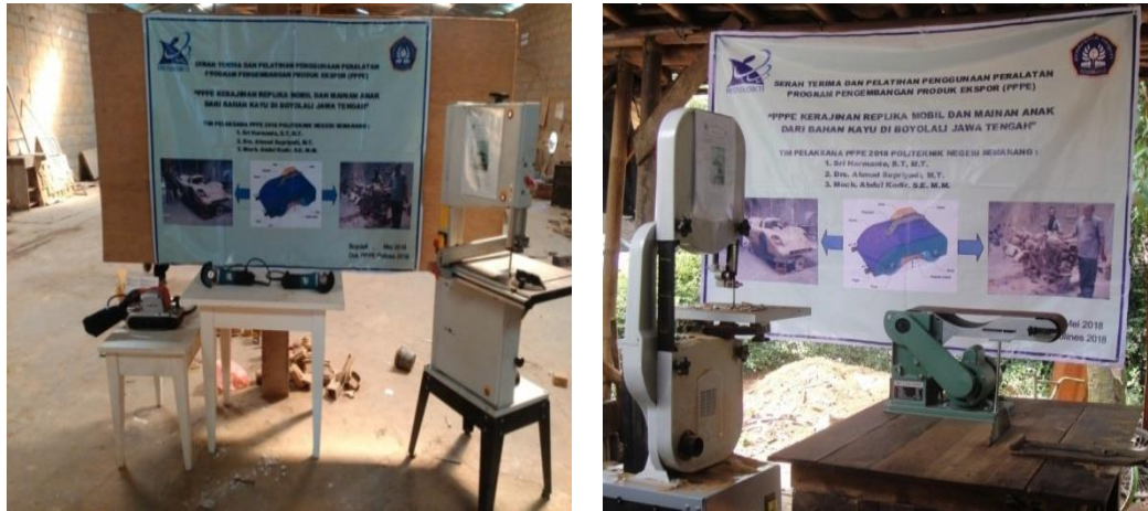
Gambar 6. Peralatan mesin gergaji pita dan mesin pengampelas sabuk Sumber : Kegiatan Pengabdian Masyarakat Program PPPE Tahun 2018
