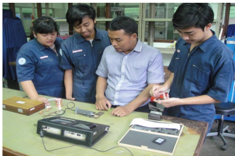
Gambar 6. Pengujian kekasaran bahan aluminium, kayu jati, dan mahoni (Harmanto, S., 2018)
