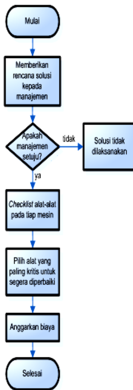
Gambar 4. Diagram Alir Perbaikan Alat pada Mesin
