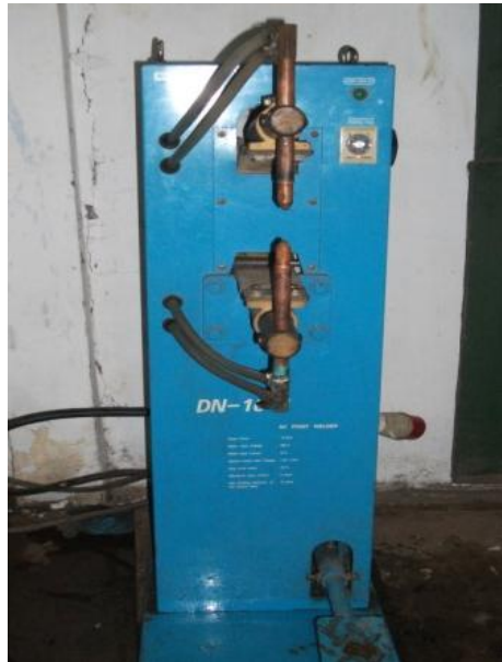
Gambar 3. Mesin spot welding pada eksperimen
