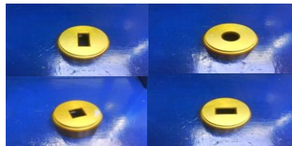
Gambar 8. Hasil rancangan nosel berpenampang lingkaran dan segiempat
