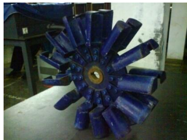
Gambar 9. Rancangan runner turbin pipa belah dua
