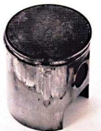
Gambar 1. Kerusakan pada crown piston [2]
