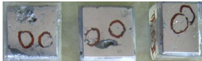
Gambar 6. Specimen produk cor hasil penuangan pada cetakan tipe conical basin
