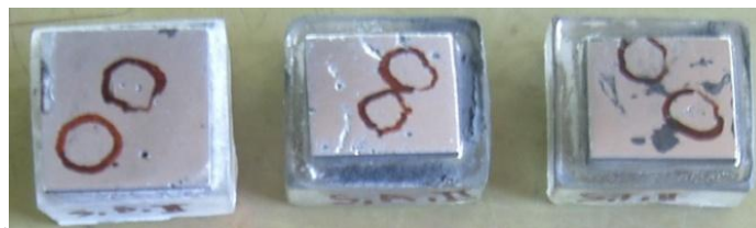
Gambar 7. Specimen produk cor hasil penuangan dengan cawan tipe offset basin
