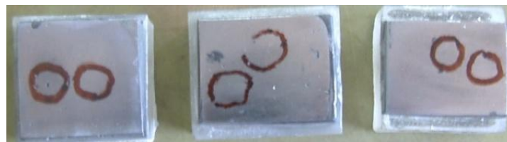
Gambar 8. Specimen produk cor hasil penuangan dengan cawan tipe offset stepped basin
