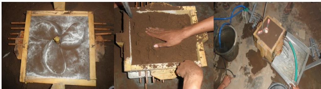
Gambar 6. Proses pengecoran cetakan pasir dengan metode pembekuan searah
