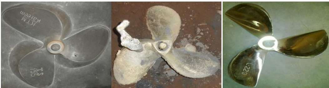
Gambar 4. Pola cetakan logam dan produk cor propeler kapal tiga sudu
