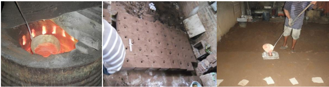
Gambar 3. Peleburan logam dan pengecoran dengan pasir cetak
