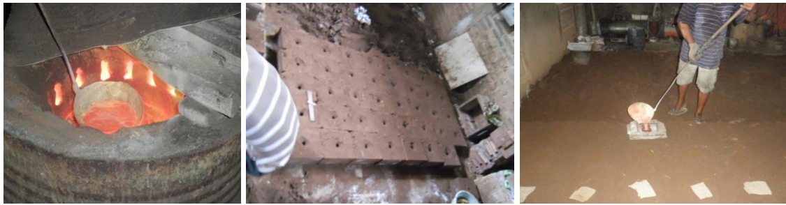
Gambar 6. Peleburan logam dan pengecoran dengan pasir cetak
