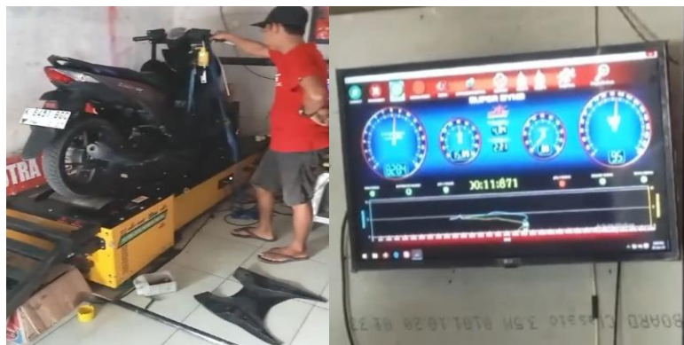
Gambar 3. Proses pengujian torsi dan Tampilan Monitor Dynotest
