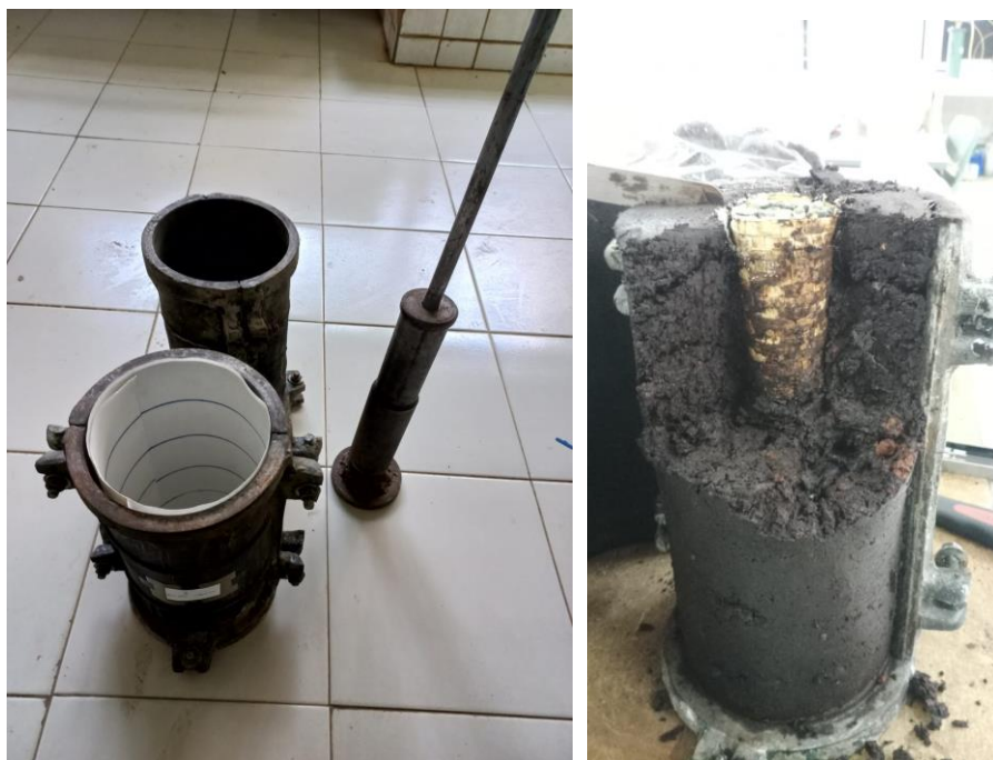
Gambar 4. Benda uji CBR
