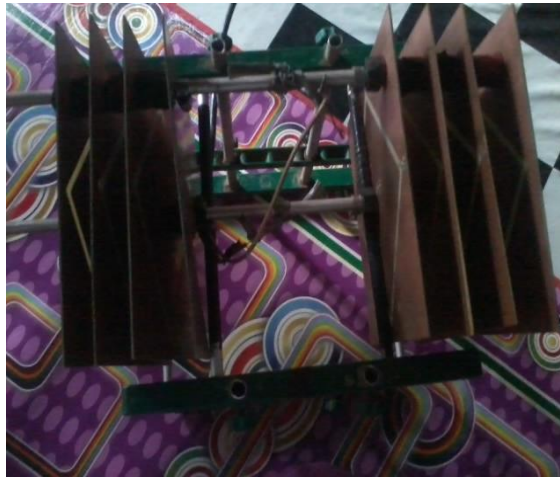
Gambar 4. Bentuk fisik antenna microstrip yang dibuat
