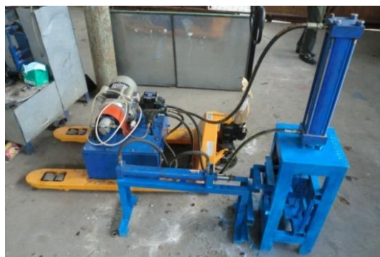
Gambar 1. Mekanisme pengecoran squeeze yang dikembangkan
