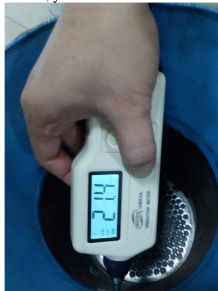
Gambar 2. Pengukuran getaran menggunakan vibration meter
