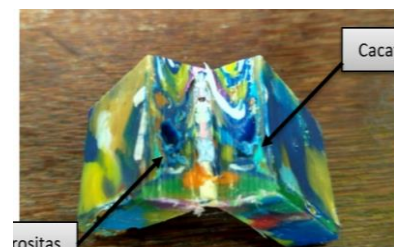
Gambar 7. Sampel cacat porositas
