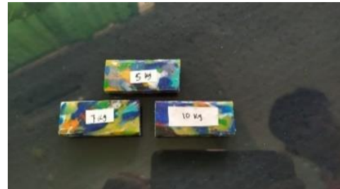
Gambar 5. Hasil potongan sampel uji densitas
