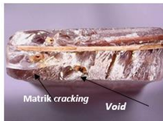
Gambar. 6. Foto makro fraksi volume 95% resin dan 5% serat acak.
