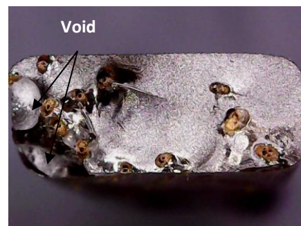
Gambar.10. Foto makro fraksi volume 90% resin dan 10% serat searah
