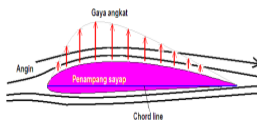
Gambar 3. Laju aliran udara pada penampang airfoil
