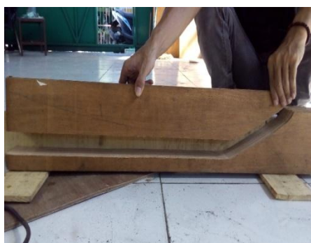
Gambar 2 Cetakan limb dari kayu
