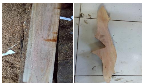
Gambar 5 Desain riser dan hasil jadi riser
