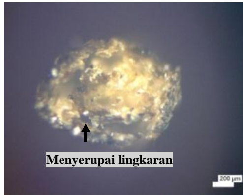
Gambar 4. Foto mikro penampang kulit eceng gondok yang dipilin tampak atas
