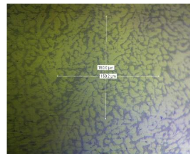
Gambar 3 alumunium dengan campuran alumina 5%
