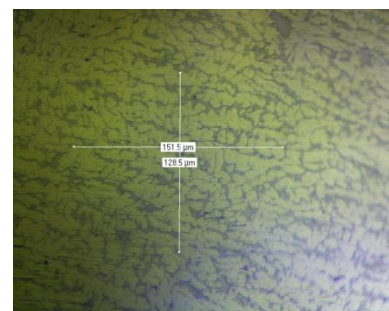
Gambar 4 alumunium dengan campuran alumina 10%
