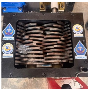
Gambar 13. Sudut 90° terjadi macet
