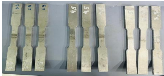
Gambar 7 Spesimen Uji Tarik ASTM E8
