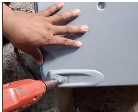
Gambar 3. Proses melubangi cover armrest dengan cara manual
