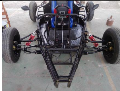
Gambar 12 Hasil Akhir Pembuatan Sistem Kemudi Rack and Pinion dan Suspensi Independent Double Wishbone Mobil Listrik
