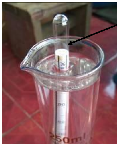
Gambar 2. Hasil Pengukuran Kadar Bioetanol Setelah Melalui Proses Dedidrasi
