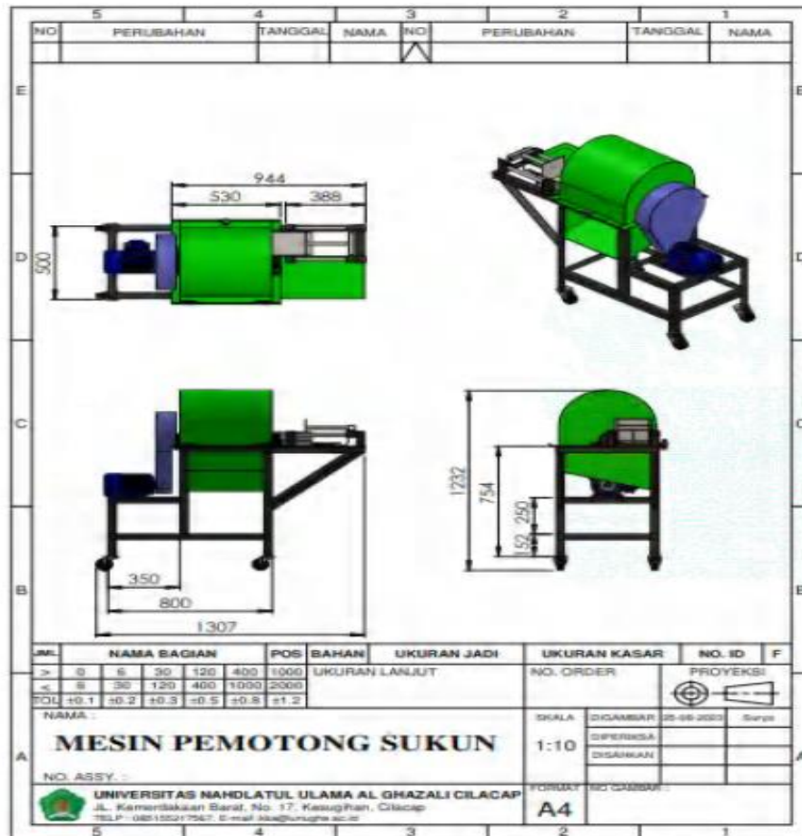
Gambar 5. Desain Alat Pemotong Sukun Tampak Dari Berbagai Sisi
