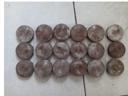
Gambar 6. Spesimen Baja AISI 4340 sebelum di blasting
