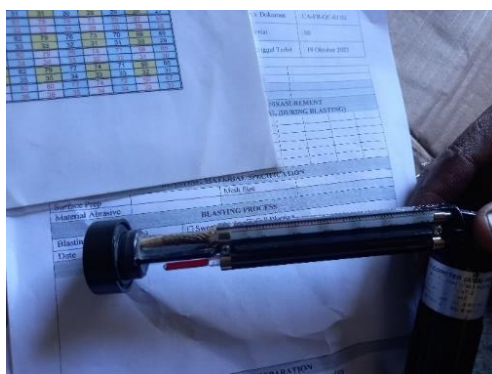
Gambar 5. Environment test menggunakan alat sling psychrometer
