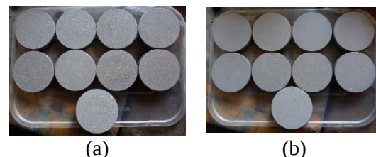
Gambar 7. Spesimen Baja AISI 4340 (a) yang telah di blasting menggunakan aluminium oxide dan (b) yang telah di blasting menggunakan pasir silika
