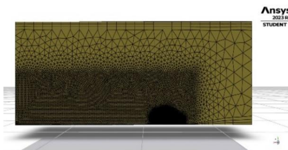
Gambar 4. Proses meshing pada bentuk bodi kendaraan Kalimasada.
