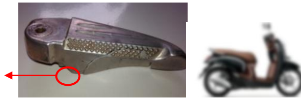
Gambar.1 Kerusakan retak footrest sepeda motor Y
