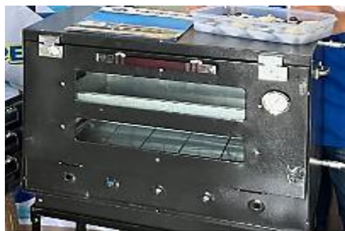
Gambar 8. Oven gas manual yang sudah siap digunakan
