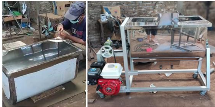
Gambar 9. Proses perakitan mesin pencuci kacang hijau
